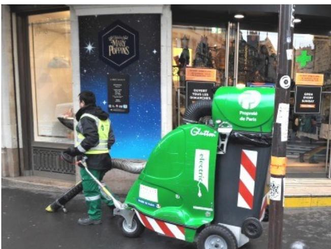
L'équipage est constitué d'un engin comme celui-ci, inédit dans le paysage parisien, avec sa longue trompe aspirante de gros diamètre et d'un opérateur qui dirige en même temps le tuyau et le chariot vers les déchets sur la chaussée et les trottoirs. Est-ce la solution au problème de la saleté endémique de Paris ? Peut-être, si la municipalité consent à changer ses priorités.
